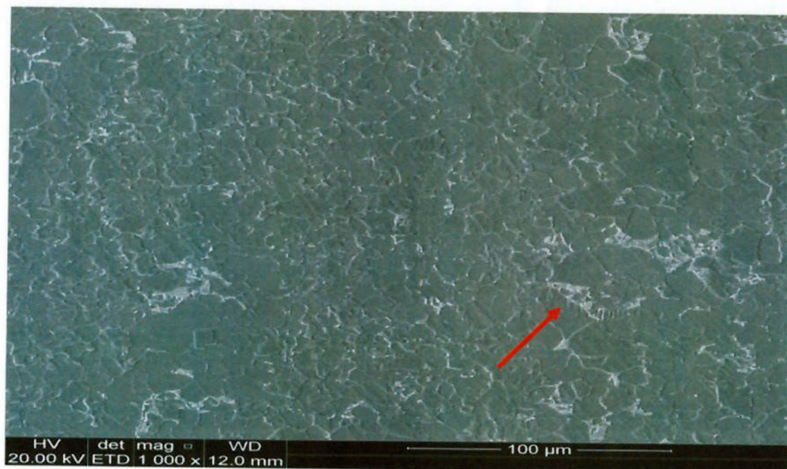
Figura 33. Imagem da microestrutura do metal de base. Ataque Nital 2%. Aumento de 1.000x.
