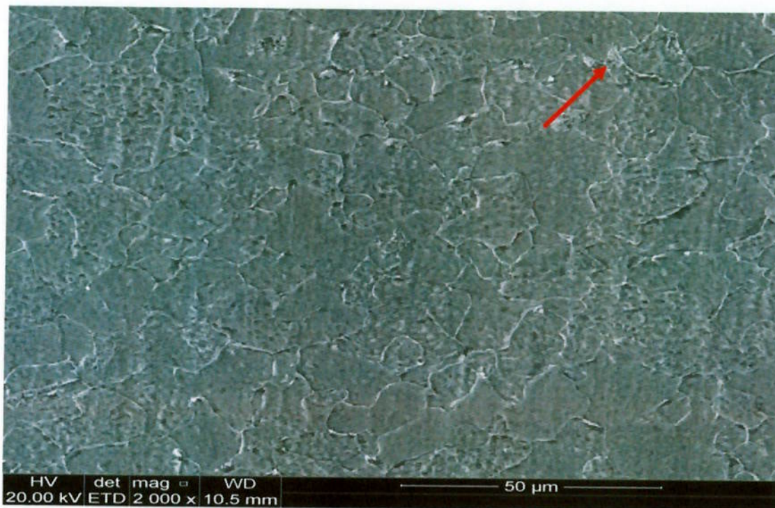
Figura 28. Imagem da microestrutura na zona afetada pelo calor próxima ao centro da junta. Ataque Nital 2%. Aumento de 2000x.
